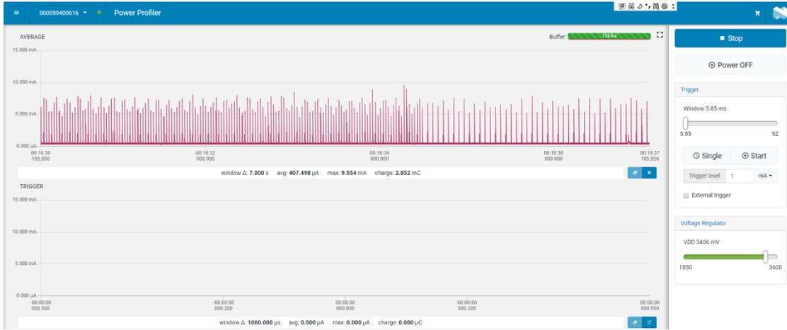
2、可正常工作模式+低功耗（AT+SL 进入，IO P18 拉低 1 秒退出）
